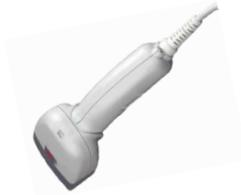
Ähnlich funktioniert die Scannerkasse im Supermarkt. An dem Strommuster wird der Strichcode erkannt und ihm die entsprechende Ware geordnet.
